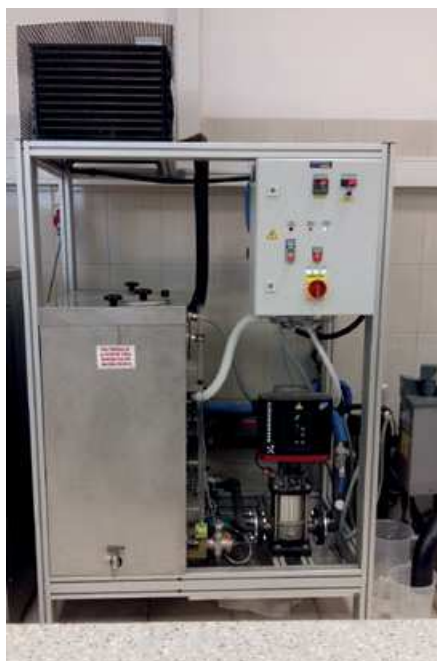
Slika 7: Naprava za pripravo testne vode za merjenje pralnih učinkov po evropski energijski nalepki, proizvajalca Gorenje Orodjarna, Merilni sistemi
