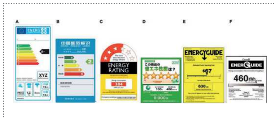
Slika 2: Prikaz energijskih nalepk za pralne stroje po različnih trgih: A – evropska energijska nalepka, B – kitajska energijska nalepka, C – avstralska energijska nalepka, D – japonska energijska nalepka, E – ameriška energijska nalepka in F – kanadska energijska nalepka
