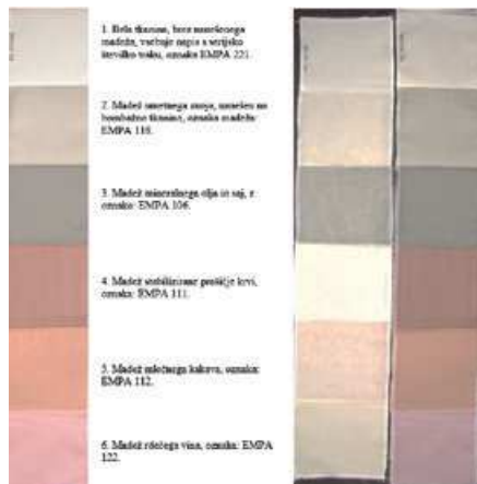
Slika 4: Levo: Testni trak za merjenje pralnega učinka s petimi testnimi madeži, z oznako EMPA 108, proizvajalca WFK, serijske številke WFK 1206.054, desno: primerjava med neopranim in opranim testnim trakom, serije WFK 1206.054, na programu Bombaž 60 °C
