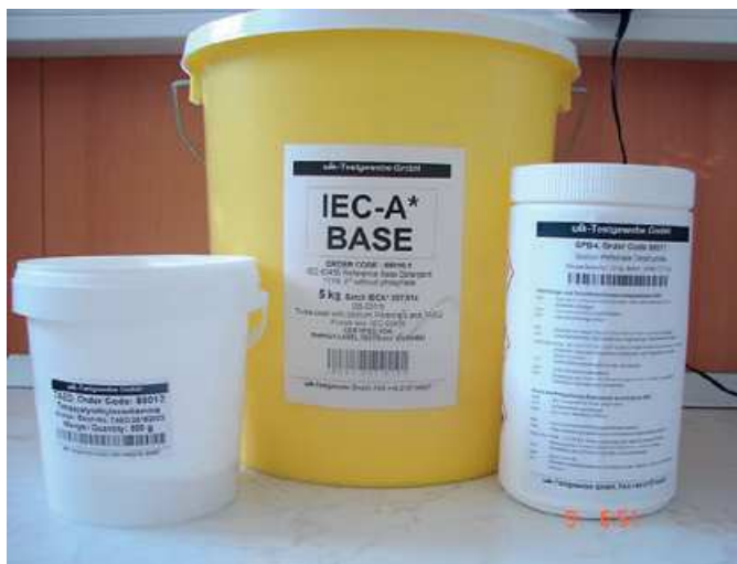
Slika 8: Standardni detergent IECA* osnovni, aktivator TAED in SPB4, za merjenje pralnega učinka, proizvajalca WFK, Nemčija
